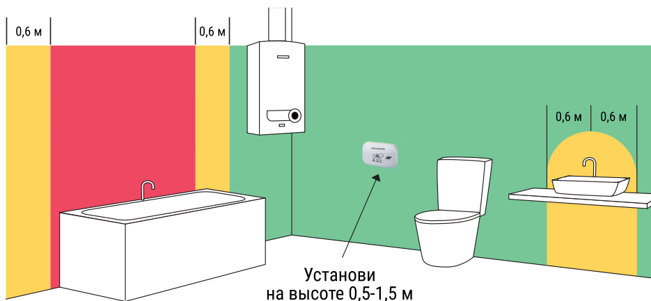
Установка датчика угарного газа в ванной комнате
